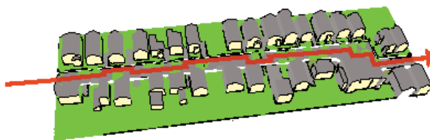
adoptimi i Konceptit Woonerf në disa lagje Karakteristikat: Shpejtësi e ulët e makinave, Rrugë gjarpëruarë (me xhepa parkimi), Rrugë të gjelbëruara, Rrugë gjysëm kembësore.
