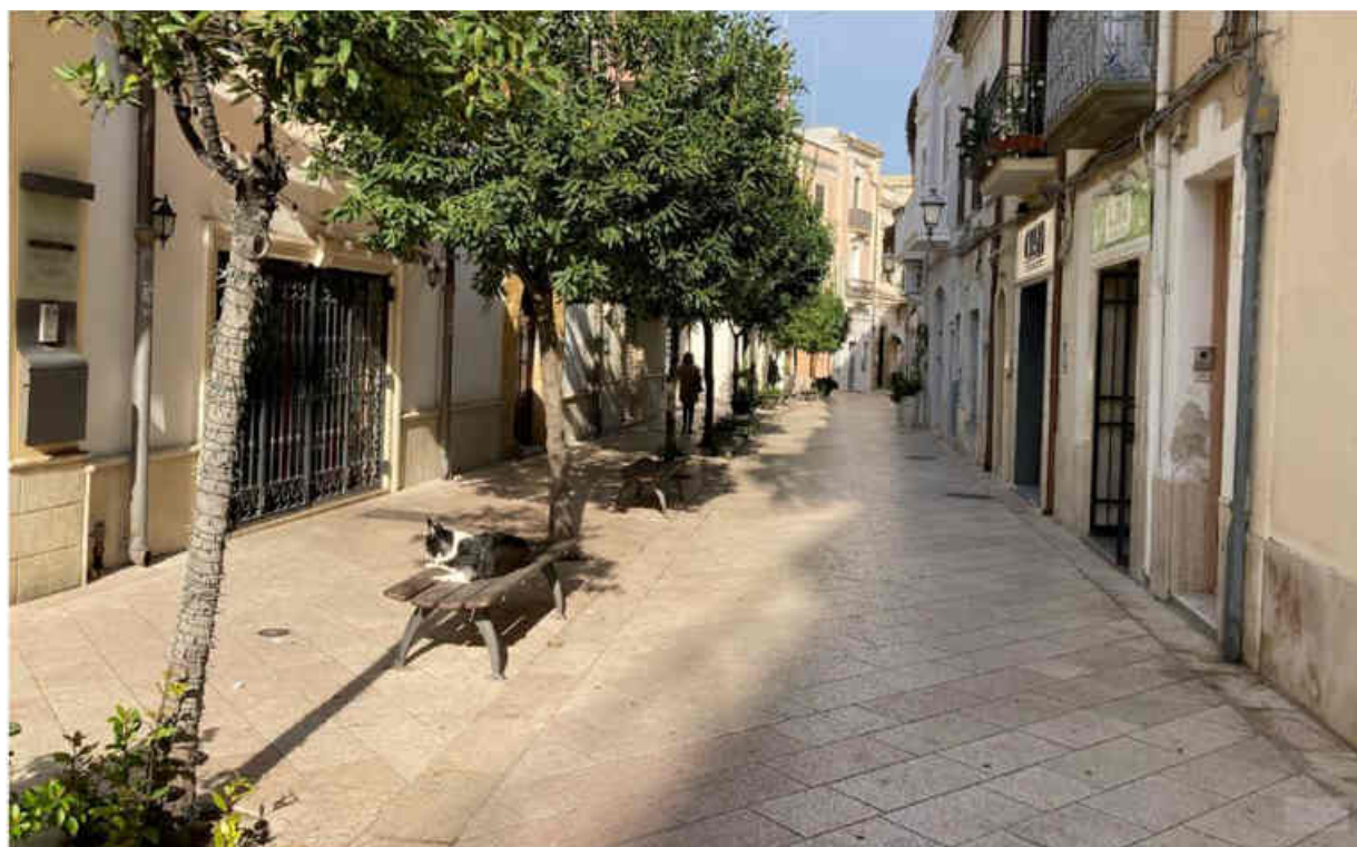
Figura 4.19: Pemë dhe stola të vendosura në mënyrë të alternuar për të siguruar rrugën për këmbësorë dhe për të shmangur parkimin në Brindisi, Itali
